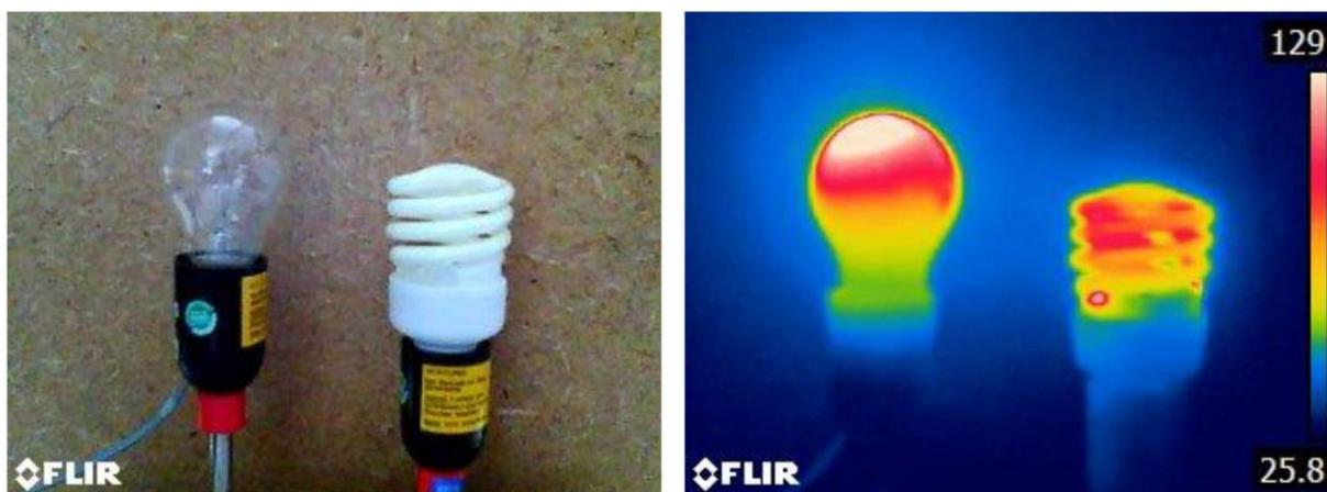
Abb. 15: Das linke Bild zeigt die Lampen im sichtbaren Licht im ausgeschalteten Zustand, um eine Überbelichtung des Fotos zu vermeiden. Im rechten Bild sind die Lampen im angeschalteten Zustand im Infrarotbereich zu sehen. Der Übergang von Rot zu Weiß zeigt, dass die Glühlampe heißer als die Energiesparlampe wird.
