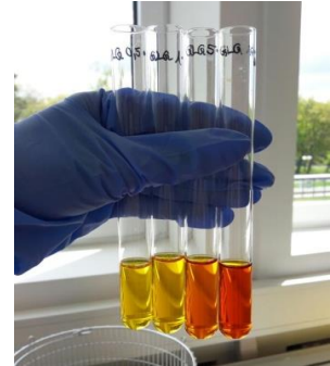
Abb. 5: Farbumschlag von DNS bei unterschiedlichen Konzentrationen
