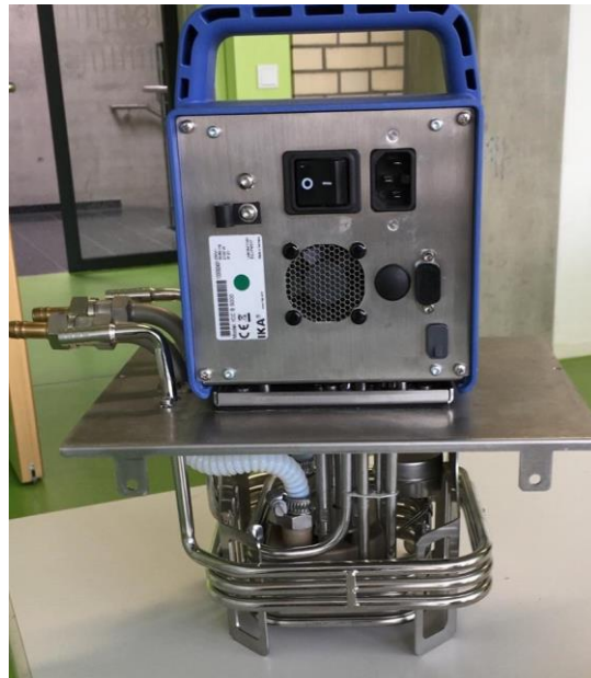
Abb. 3: Thermostat (ICC, IKA-Werke GmbH & Co. KG, Staufen) mit eingebauter Pumpe
