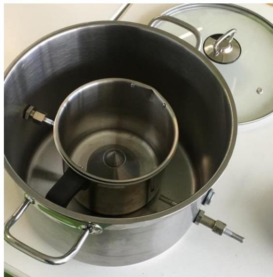
Abb. 5: Stählerner Rührreaktor (WMF Group GmbH, Geislingen an der Steige) im Wasserbad
