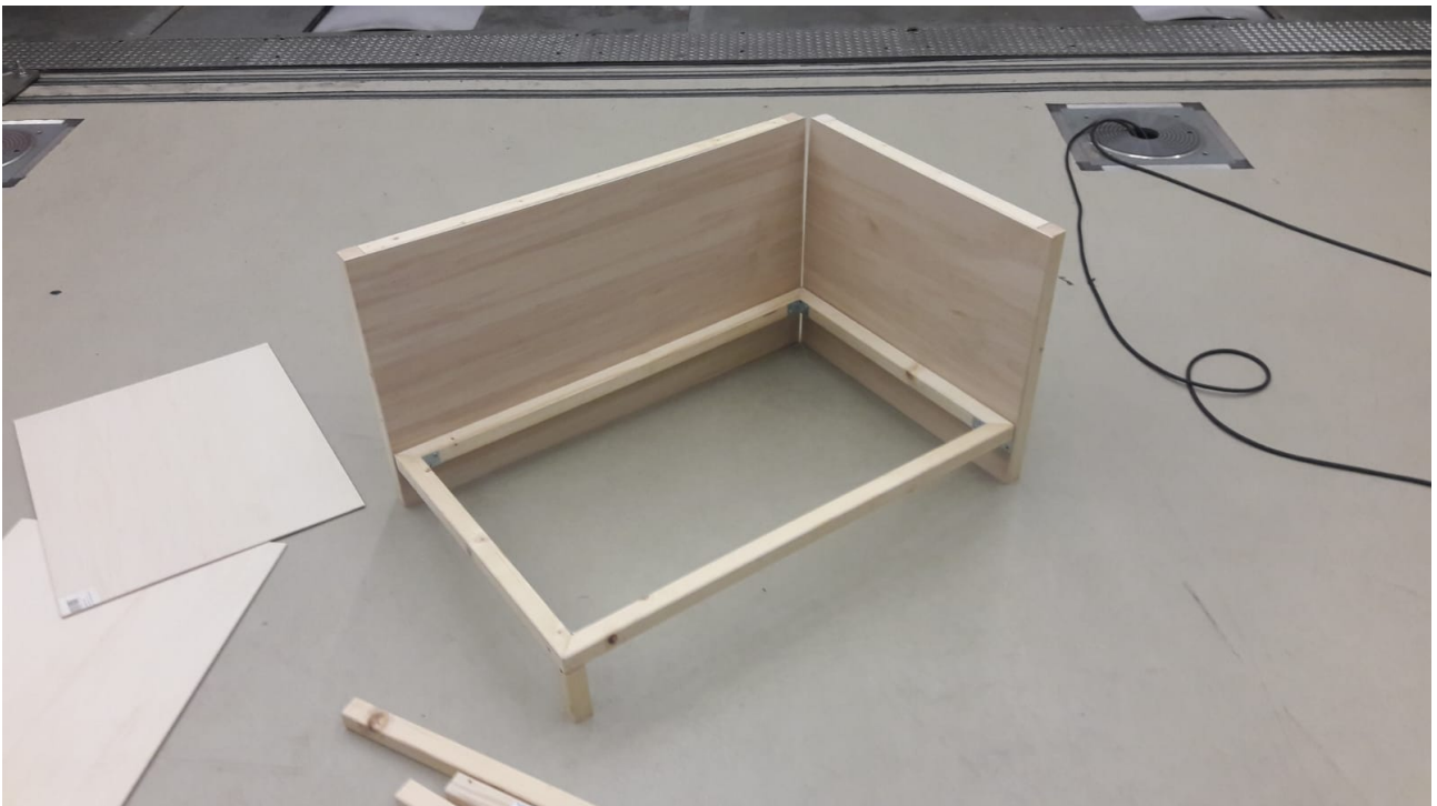
Abbildung 7: Grundgerüst aus Holz
