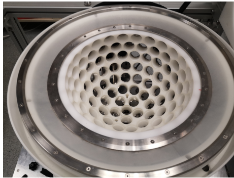
(b) Nahaufnahme des Wasserbeckens (noch ohne Ultraschallwandler).
