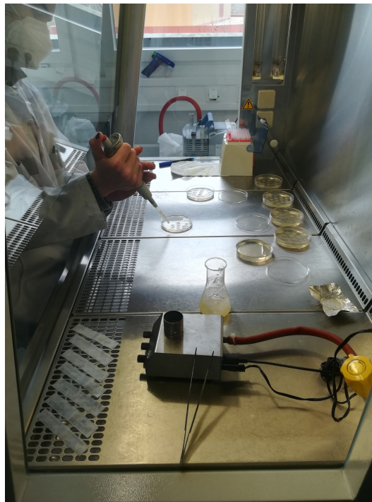
Abbildung 4: Sterilbank beim Ansetzen der Festkultur aus einer Flüssigkultur. Die Zellen im flüssigen Medium werden auf das feste Medium getropft.
