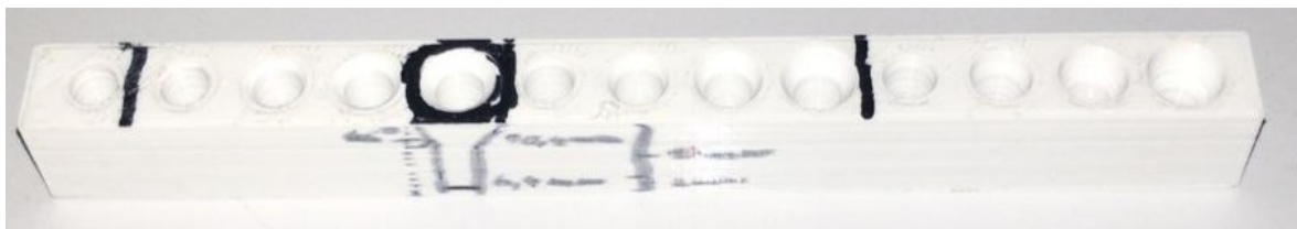
Abbildung 5: Teststück für Winkel und Durchmesser
