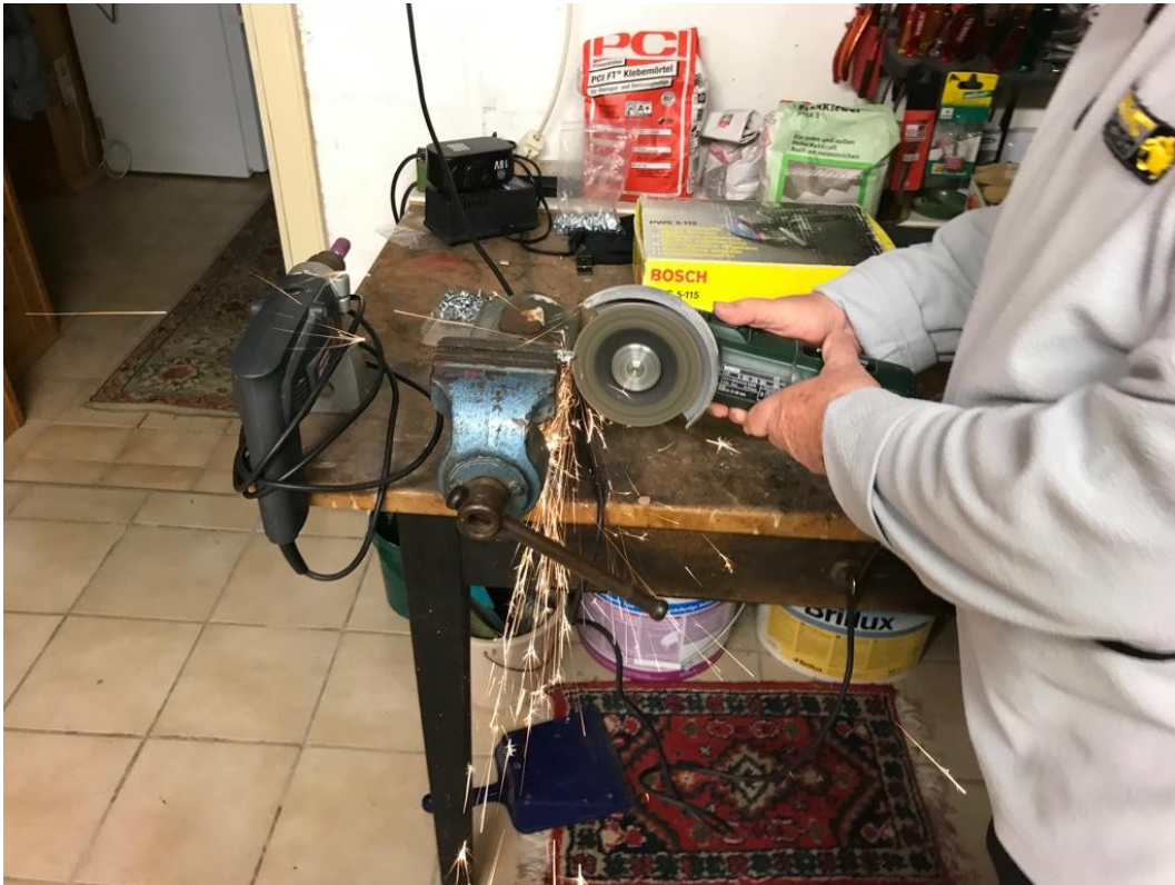
Abbildung 16: Schraubenkopf wird gekürzt
