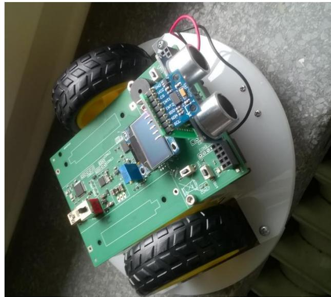
Im Gegensatz zu kommerziellen Robotersystemen können moderne Programmiertechniken (Time Interrupt, AD-Wandler, verschiedene Regler, Messwerterfassung) sowie die Visualisierung von Messdaten problemlos und umgesetzt werden. Durch Bluetooth können Befehle an den Roboter Messwerte, aber auch Daten an den Rechner übertragen werden.
