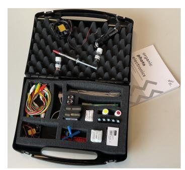
befassen und – nachdem wir die Theorie durchdrungen haben – selbst Leuchtdioden und Photovoltaikmodule aus organischen Stoffen fertigen, testen, messen und bewerten.
