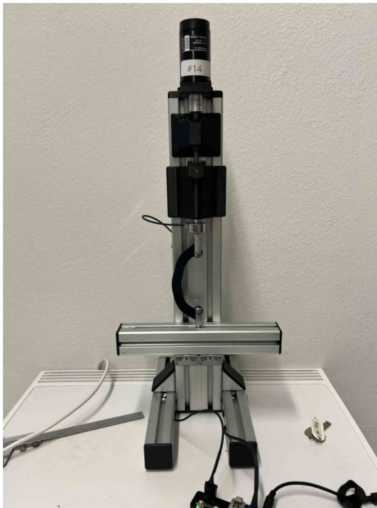
Abb. 8: Zugmaschine mit eingespanntem Brakebooster
